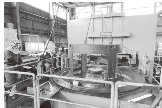
平成30年12月に稼働を始めた大型CIP。大型製品の製造と成形時間の短縮を実現
